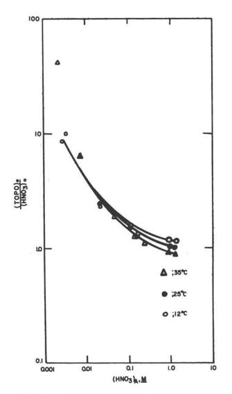
FIGURE 2. RATIO OF ORGANIC REAGENT TO NITRIC ACID CONCENTRATION IN CYCLOHEXANE SOLUTION AS A FUNCTION OF EQUILIBRIUM AQUEOUS ACIDITY
