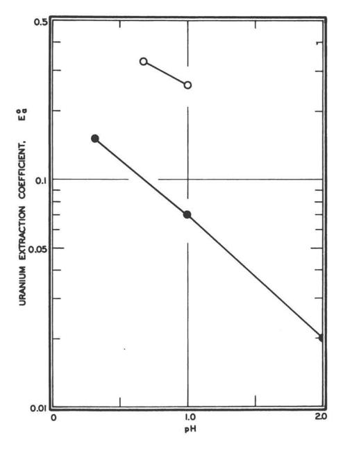
FIGURE 49. URANIUM EXTRACTION FROM PHOSPHATE SOLUTION EFFECT OF pH LEVEL
