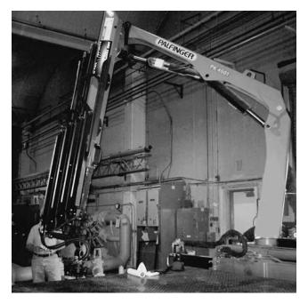
Figure 16. Palfinger PK4501C crane.
