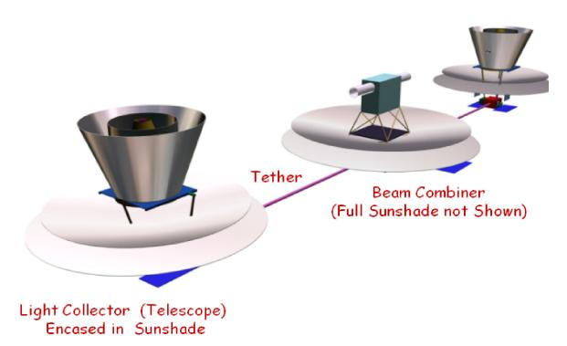
Kilometer-Baseline Far-Infrared/Submillimeter Interferometer<sup>10</sup>
