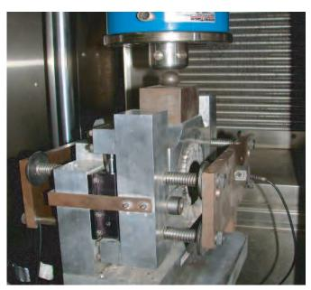
(d) Application of shear loading
